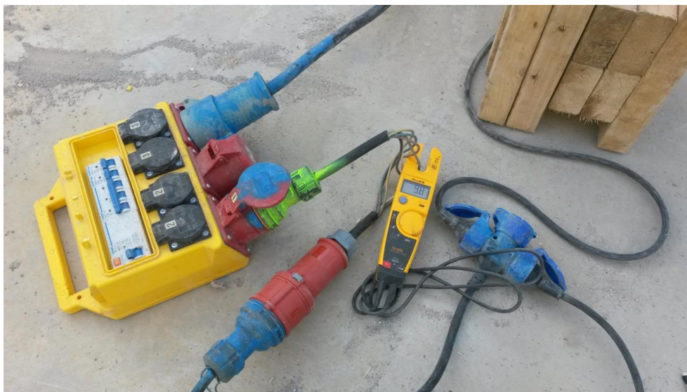
Figur 3-22 Mätning av strömförbrukning.
