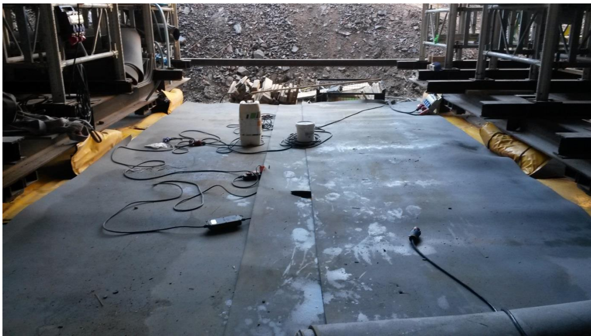
Figur 3-13 Värmemattorna vid utläggning efter att de täcktes med isolering, försök 3. Mätpunkternas horisontella läge markeras av de två hinkarna.
