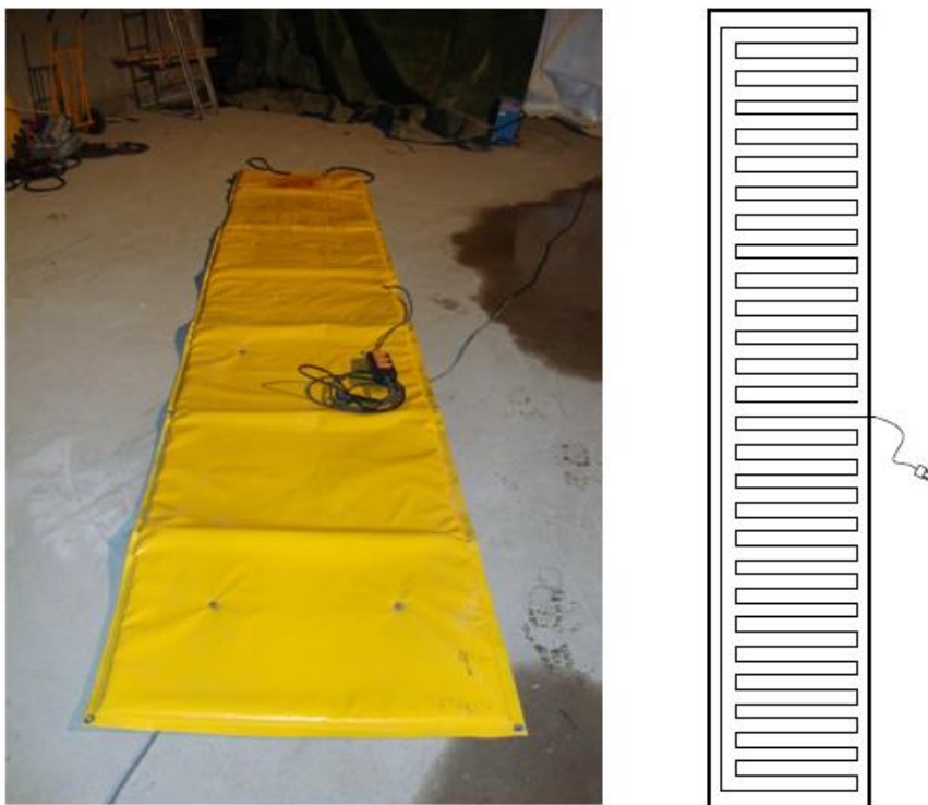
Figur 3-1 Värmemattan som behandlas i detta arbete. Den högra bilden visar schematiskt hur värmekablarna är dragna.
